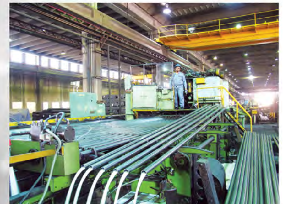
كل أنبوب يخضع لإختبار الضغط العالي Hydrostatic Test for every pipe produce at SSP
